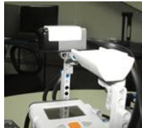
Figura 6. Sensor de campo magnético, posicionado na parte superior do robô.
