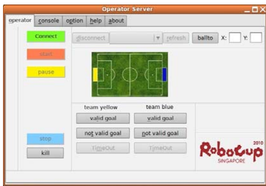
Fig. 5. Visual Operator Module
