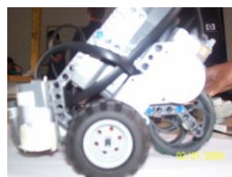
Figura 2: Vista Lateral: Detalhes da roda multidirecional traseira
